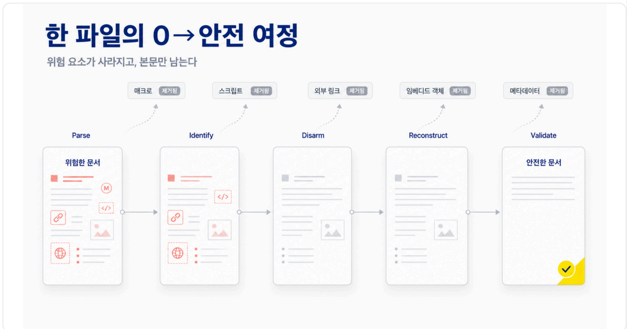
[그림 3] 한 파일의 0→안전 여정 — 5단계 파이프라인. 모든 단계는 파일을 실행하지 않는 정적 분석으로 구성됩니다. 37
